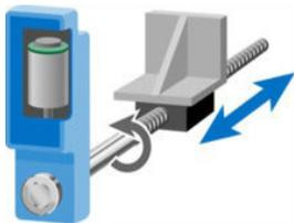
El motor incorporado gira captando la posición actual a través del codificador y deteniéndose en la posición de destino. El posicionamiento se automatiza con el tornillo sin fin.
